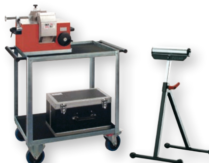
Тележка со стойкой для размещения рабочей станции обработки шин на удобной высоте
