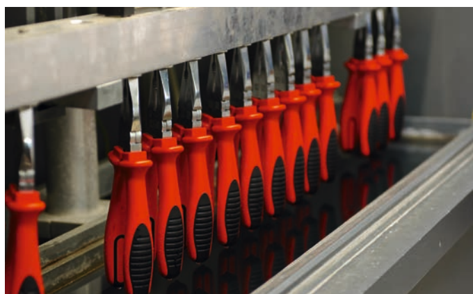
Испытание напряжением 10 кВ
