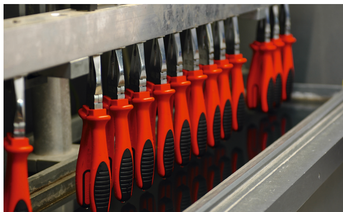
Испытание напряжением 10 кВ
