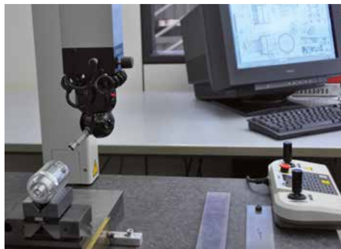
Inspektion eines Hydraulikpumpenkörpers mittels 3D-Gerät
